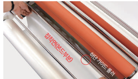
⑧ 접착면이 위로가게 하여 하단 코팅필름을 하단 가이드 롤러 아래로 통과 시켜줍니다.
