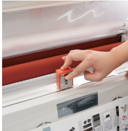
⑥ 기기 뒷면으로 완료된 코팅물이 나오면 정지 버튼을 누르고 커터로 코팅물을 잘라줍니다.
